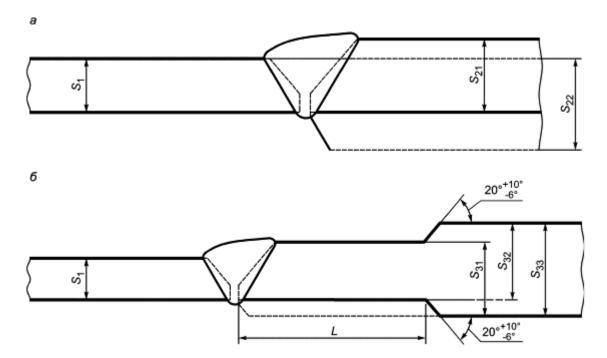
а - обработка торцов стыкуемых разнотолщинных элементов при соотношении  $S_2(S_{21},S_{22}) \leq 1,5S_1$ ;  $\pmb{6}$  - обработка торцов стыкуемых разнотолщинных элементов при соотношении  $S_3(S_{31},S_{32},S_{33}) > 1,5S_1$ .
